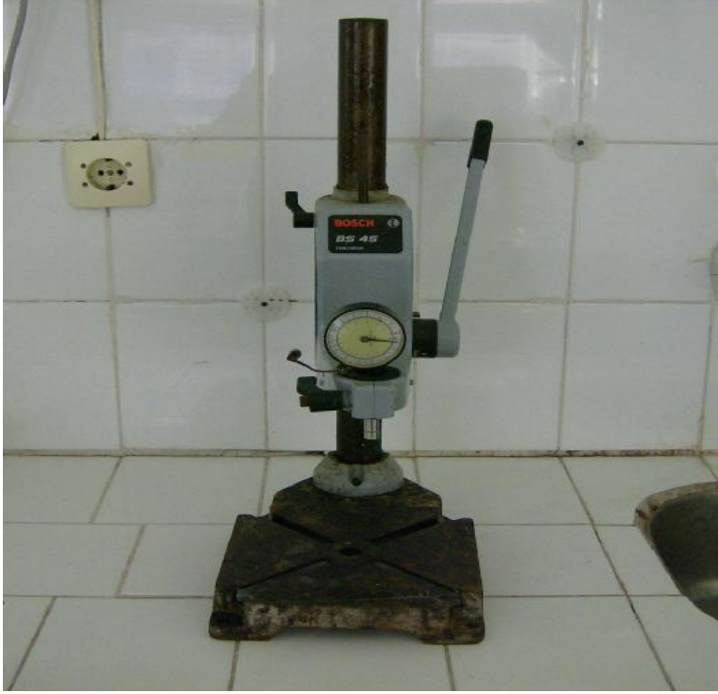
Şekil 15. Mısır Tanelerin Kuvvet Altındaki Kırılma Direnci Belirleme Deney Düzenegi GörünüŖü
