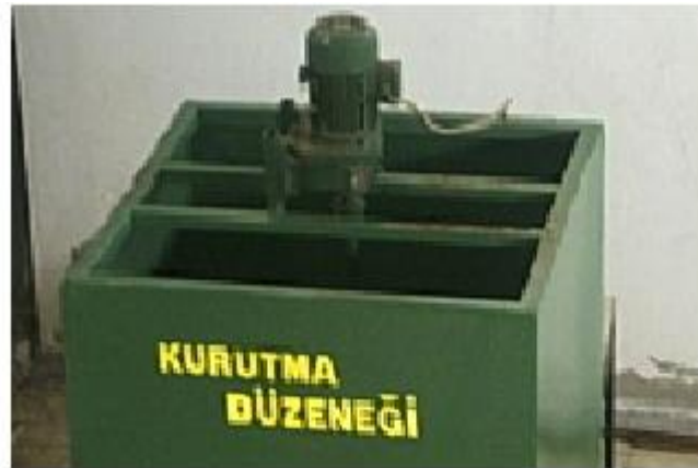
Şekil 8. Karıştırıcı Elektrik Motoru
