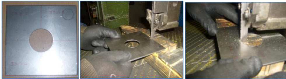
Şekil 5.7 Markalaması yapılmış numune ve kesim işlemleri
