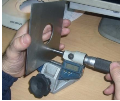
Şekil 5.5. Dijital mikrometre ile sac kalınlığı ölçümü
