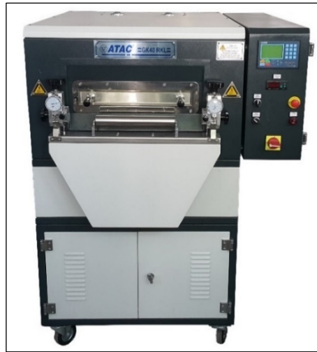
Şekil 3.4. Ataç GK40 RKL laboratuvar tipi kaplama makinesi
