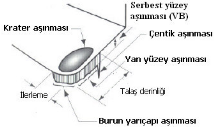
Şekil 3.13. Belli başlı aşınma tipleri
