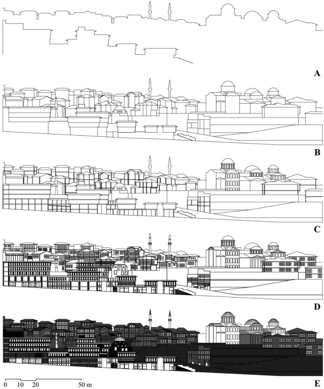
Şekil 3.6. En az karmaşık olandan en çok karmaşık olana doğru sıralanan görsel katmanlar. A) Silüet B) Kitle düzeni C) Strüktür D) Cephe düzeni E) Yüzey modülasyonu (malzeme dokuları ve/veya süslemeler)
