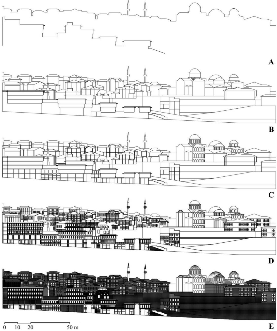
Şekil 4.6. SSK Kompleksi ve Zeyrek Mahallesi, bütünleşik doğu cephesi. A) Silüet B) Kitle düzeni C) Strüktür D) Cephe düzeni E) Yüzey modülasyonu (malzeme dokuları)
