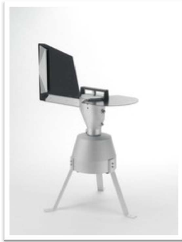
Şekil 3.1. Çalışmada kullanılan polen ve partikül toplama cihazı (Volumetric Pollen & Particle Sampler – VPPS 2000).
