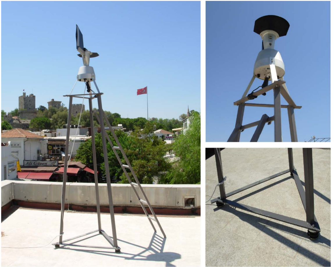
Şekil 3.2. Bodrum'da cihazın konumu ve cihazı yükseltmek için kullanılan aparat.
