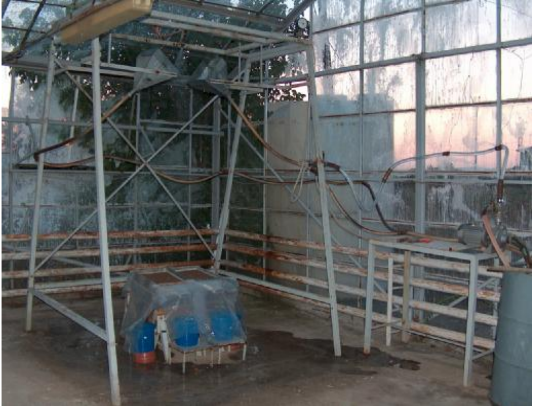
Şekil 3.4. PVA uygulanmış toprak örnekleri parselleri üzerine yapay yağış yağdırılması.
