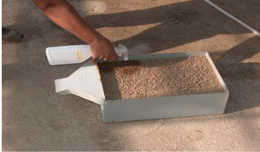
Şekil 3.2. Toprak konulmuş erozyon parseli üzerine PVA uygulanması.
