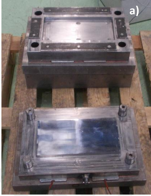
Şekil 3.11. a) Özel olarak yaptırılan SMC kalıbı b) sıcaklık kontrolü sağlayan elektrik panosu
