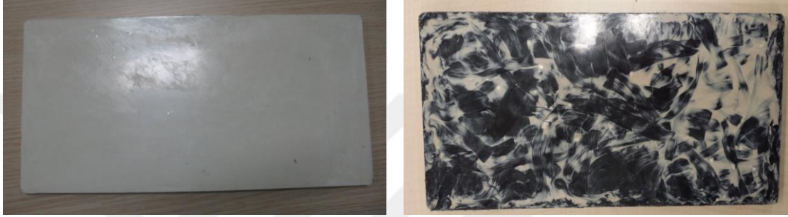
Şekil 3.13. Üretilen SMC plakalar. Solda kırılmış cam elyaf plaka sağda kırılmış karbon elyaf plaka
