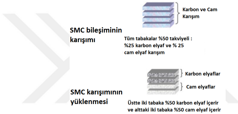
Şekil 2.5. SMC’de karbon ve cam elyafı karıştırmanın iki farklı yolu (Cabrera-Rı’os ve Castro 2006)
