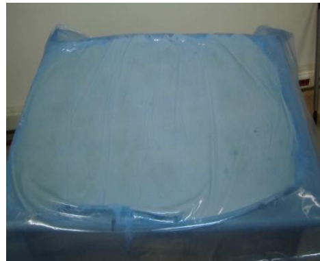
Şekil 3.6. Kesikli rasgele cam elyaf dağılımlı SMC pestiller
