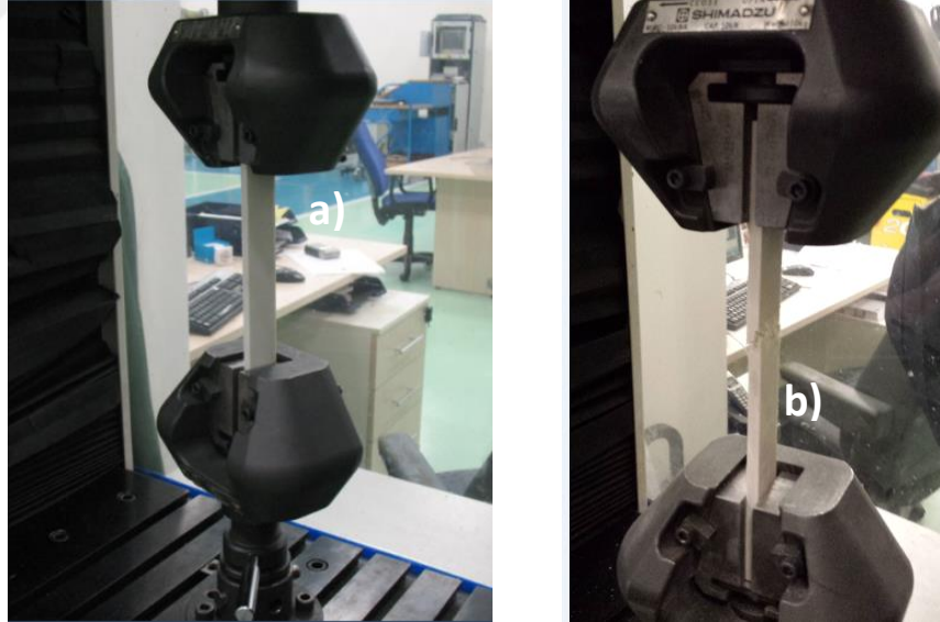
Şekil 3.16. Numunenin çekme cihazında teste tabi tutulması a) Numunenin test cihazına bağlanması, b) Kırılan çekme deneyi numunesi
