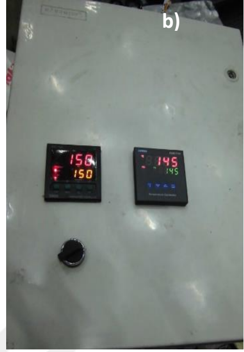
Şekil 3.11. a) Özel olarak yaptırılan SMC kalıbı b) sıcaklık kontrolü sağlayan elektrik panosu
