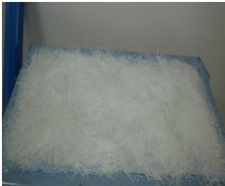
Şekil 3.6. Kesikli rasgele cam elyaf dağılımlı SMC pestiller
