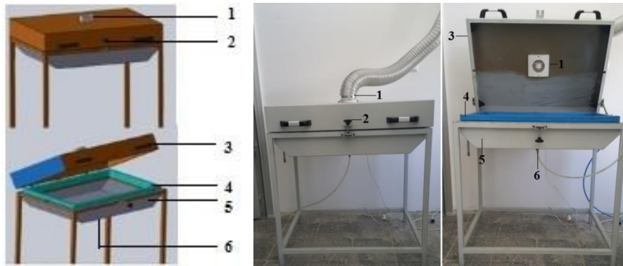
Şekil 3.2. Ozon aşındırma baskı ekipmanı şeması (1.Ozon Tahliye Fanı, 2.Vida, 3.Üst Kapak, 4. Şablonlar, 5.Konik Alt Tank, 6. Ozon Besleme Girişi)
