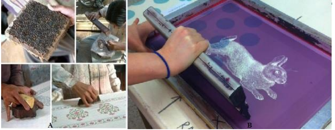
Şekil 2.2. a)Desenlerin tahta gövdelere oyularak kumaşa basılması şeklinde yapılan yapılan blok baskı görüntüsü b)Şablon yardımı ile yapılan baskı ( http://meghancarter.com/420-blockprint-bedding-linens-and-fabric-10-great-sources/ , 2017, https://www.we-heart.com/2013/04/11/thornback-peel-london/ , 2017)
