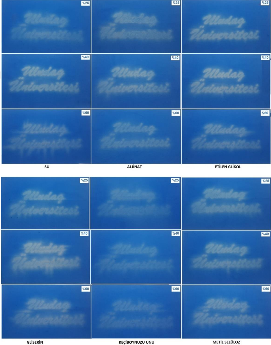
Şekil 4.2. Konvansiyonel aşındırma baskı yöntemi ve 10 l/dk.ve 10 dk. ozon gaz akış oranı ve ozonlama süresi ile üretilmiş aşındırma baskılı numunelerin fotoğrafları
