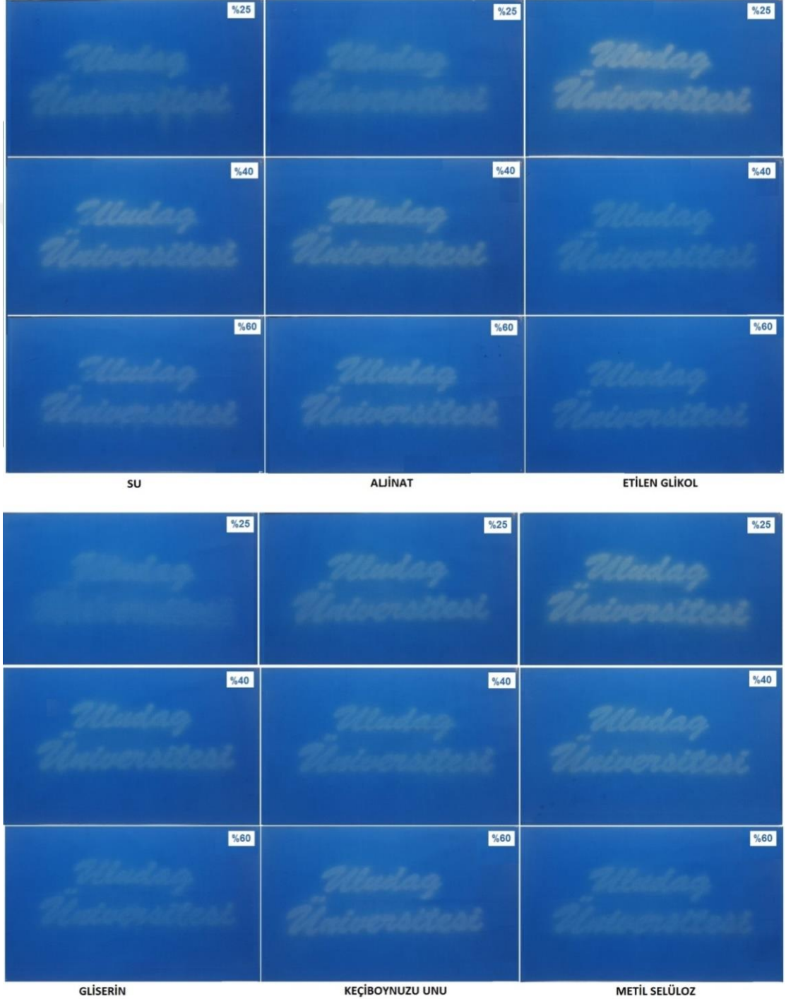
Şekil 4.1. Konvansiyonel aşındırma baskı yöntemi ve 5 l/dk. ve 5 dk. ozon gaz akış oranı ve ozonlama süresi ile üretilmiş aşındırma baskılı numunelerin fotoğrafları
