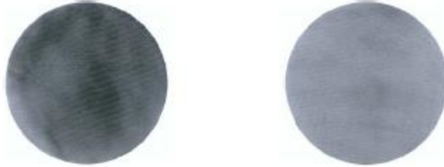
Şekil 3.1. Konvansiyonel yöntemle ve ESR yöntemiyle üretilmiş 200 çapındaki sıcak iş çeliklerinin makro dağlama sonrası kesit görüntüsü.(Asan 2008)
