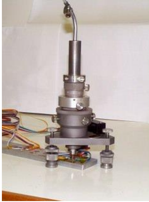
Şekil 5.2. Delik delme yöntemi ile kalıcı gerilme ölçebilen cihaz (Tekaslan 2006)
