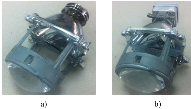
Şekil 2.6.a)Xenon far modülü b)Bi-xenon far modülü (Anonim 2013)
