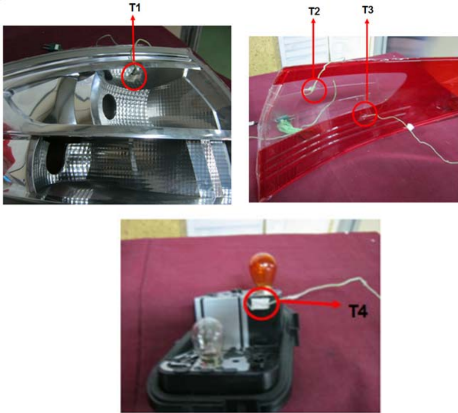
Şekil 3. 75.Arka fara yerleştirilen termokupullar
