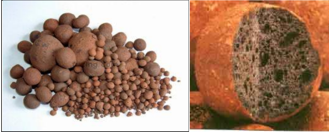
Şekil 3.10. Sistemde kullanılan yatak malzemesinin (Leca) görünümü (www.leca.ae).
