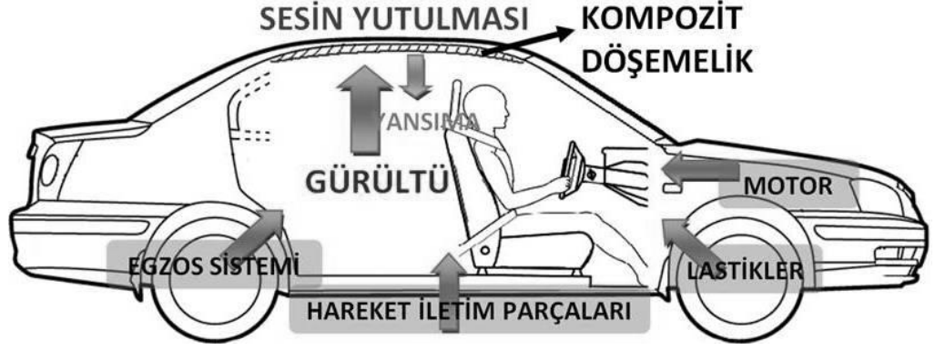
Şekil 4.45. Yolcu ve sürücü kabinine gürültü giren bölgeler
