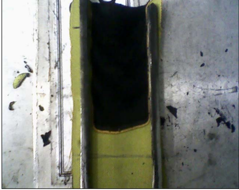
Şekil 3.1. Firetex ile işlem görmüş kumaşın LOI testinde yandıktan sonraki görüntüsü
