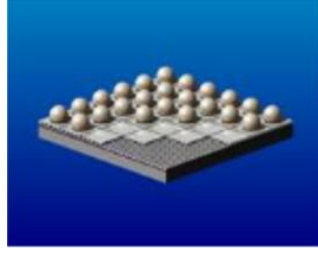
Şekil 1.1. PSRL laboratuvarında dünyanın ilk 1mΩ direnç değeri altındaki MOSFET'i (Shen 2010)
