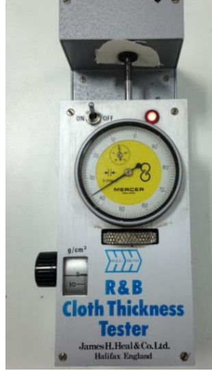
Şekil 3.8. Kumaş kalınlık ölçüm cihazı
