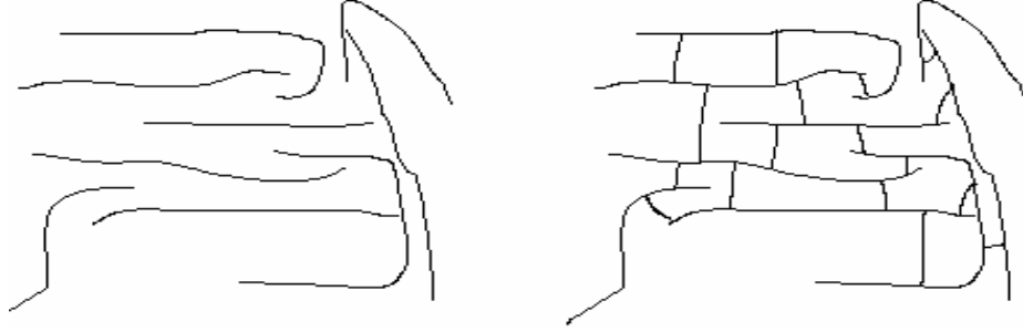
Şekil:2.10 Çapraz bağlayıcıların bağ oluşturma şekli. ( www.psrc.usm.edu )
