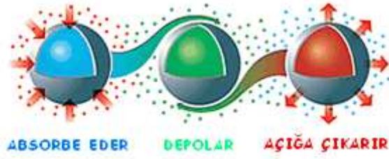
Şekil 1.7. Kapsüllenmiş FDM'lerin Çalışma Tekniği
