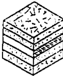
Şekil 2.4. Karma kompozitlerin yapısı (Ünal)
