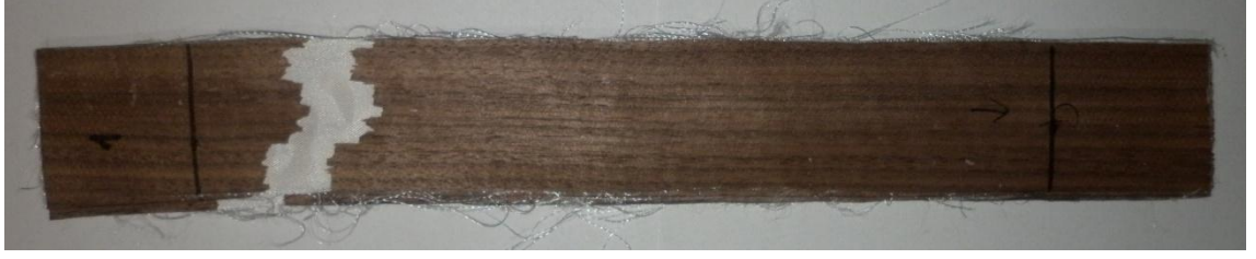
Şekil 4.1. Çekme testi sonucu ahşap kaplama ve dokuma kumaştan oluşan kompozit malzemenin görüntüsü
