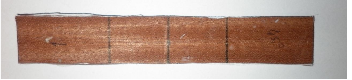
Şekil 3.10. Eğilme testi için hazırlanmış numune
