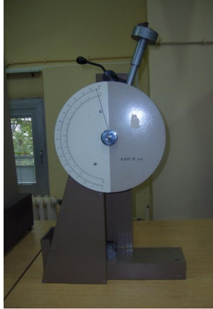
Şekil 3.13. Darbe testinin uygulanma anı
