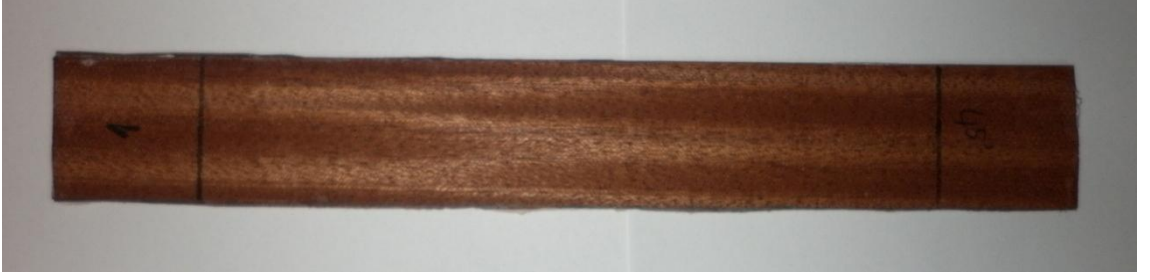
Şekil 3.8. Çekme testi için hazırlanmış numune
