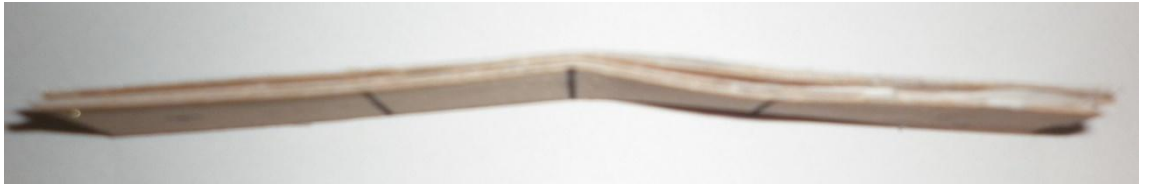
Şekil 4.7. Eğilme testi sonrası kompozit numunelerin görüntüsü
