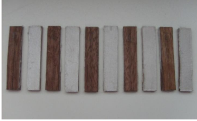
Şekil 3.12. Darbe testi için hazırlanmış numuneler
