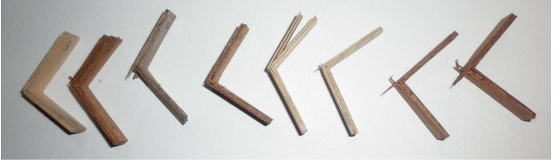
Şekil 4.12. Darbe testi sonrası kumaşsız kompozitlerin görüntüleri
