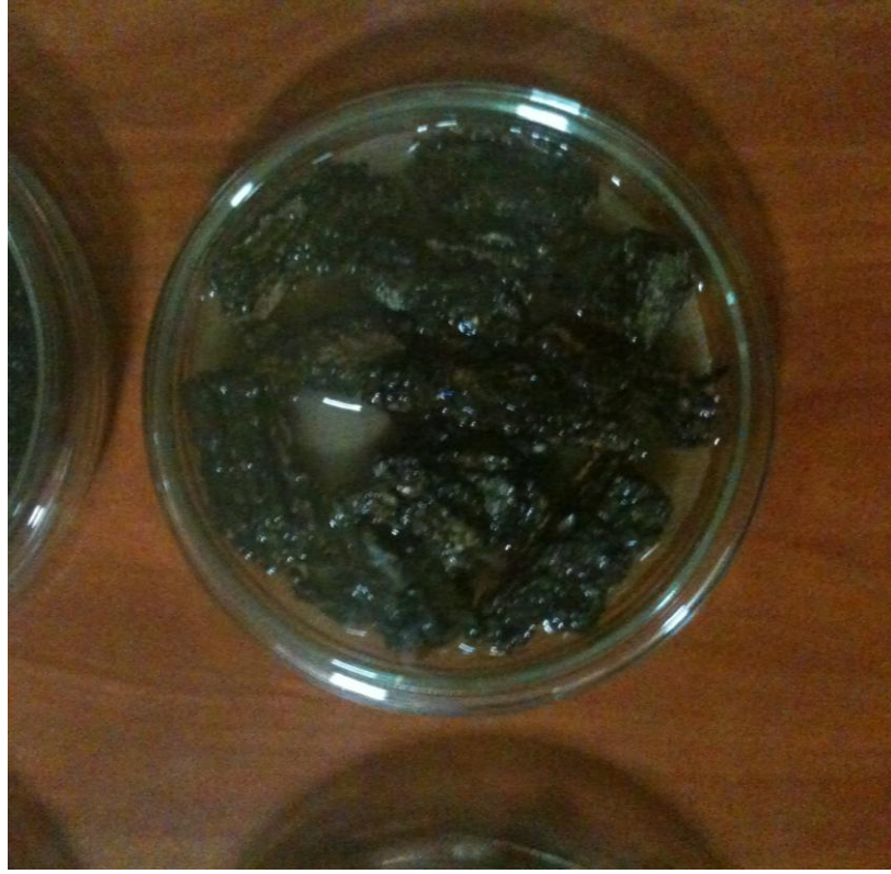
Şekil 3.2. Kabukları yerleştirilmiş ve suyu verilmiş nem odası petrisi.
