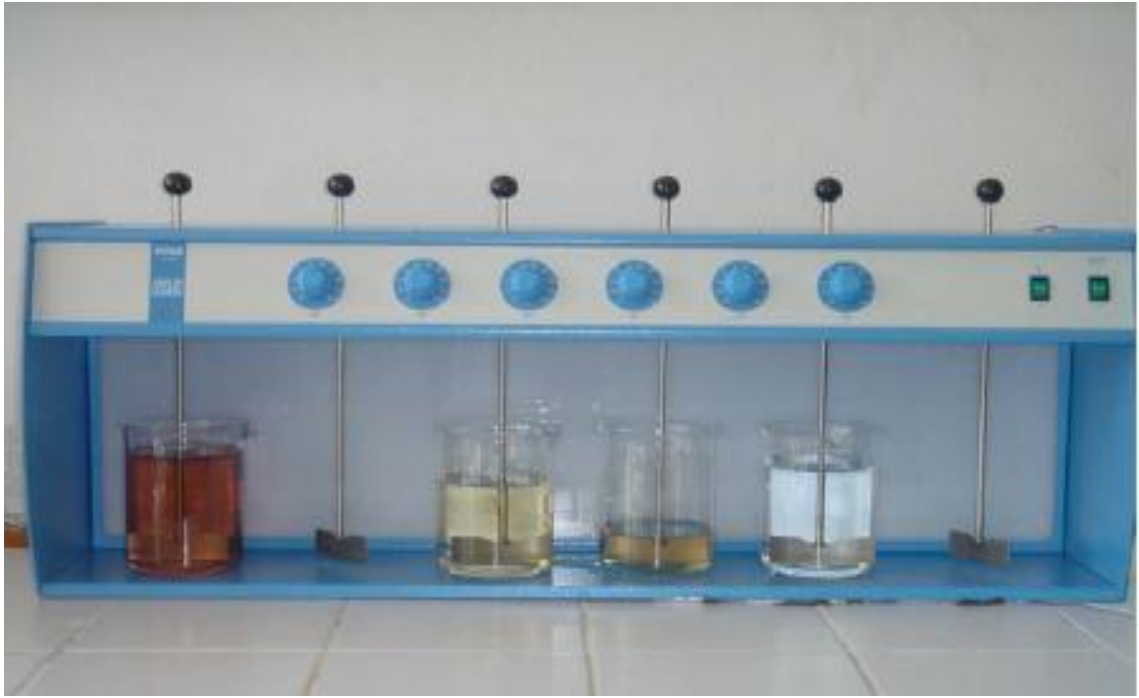
Şekil 3. 2. Fenton deneylerinin yapıldığı Jar Test düzeneği.
