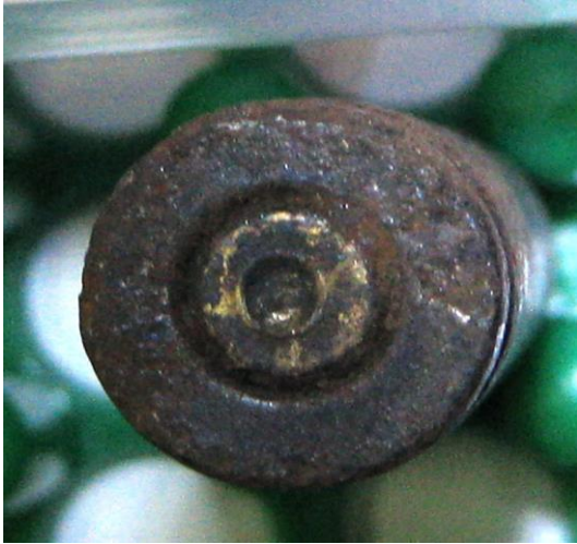
ŞEKİL: 14A- Kimyasal madde uygulanmadan önceki korozyona uğramış hali
