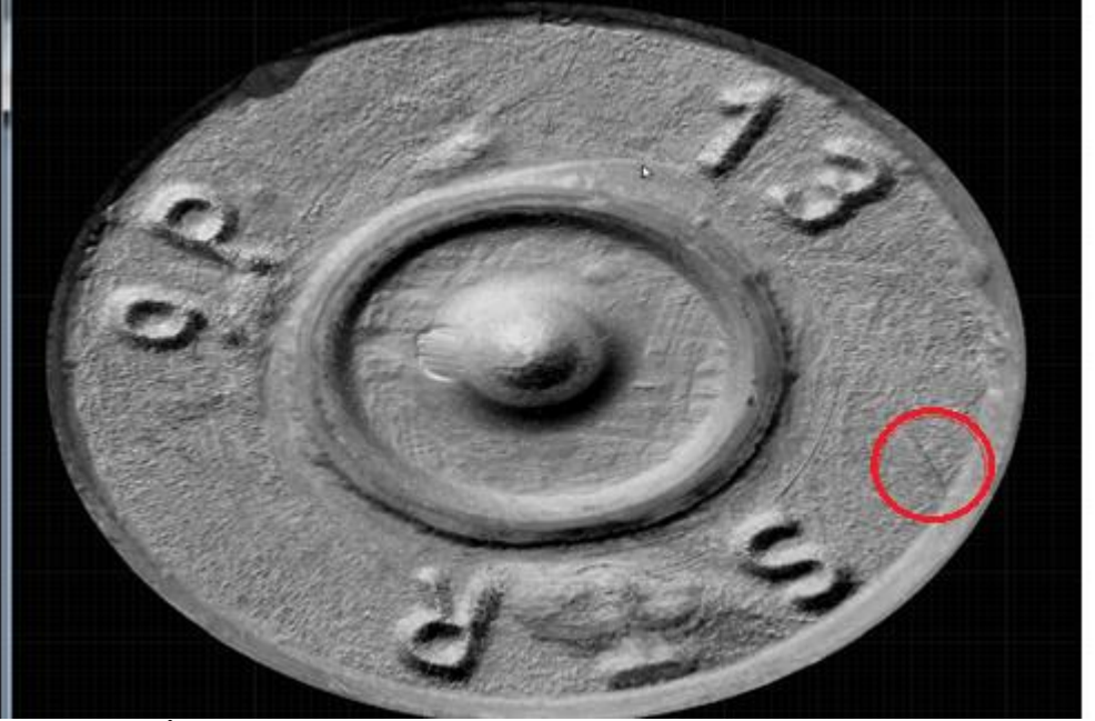
ŞEKİL: 22B- Kimyasal madde uygulanmadan önceki BALİSTİKA cihazı ile alınan veri görüntüsü
