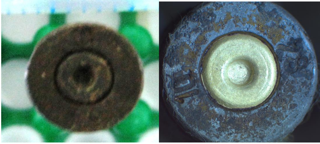
ŞEKİL: 15A- Kimyasal madde uygulanmadan önceki korozyona uğramış hali
