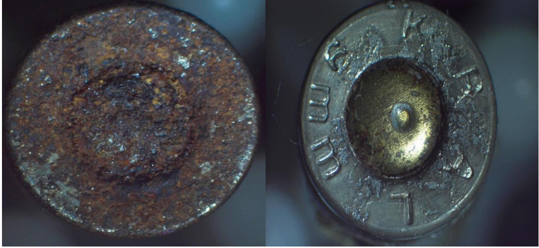
ŞEKİL: 19A Kimyasal madde uygulanmadan önceki korozyona uğramış hali
