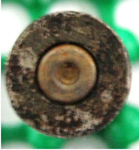
ŞEKİL: 11A- Kimyasal madde uygulanmadan önceki korozyona uğramış hali
