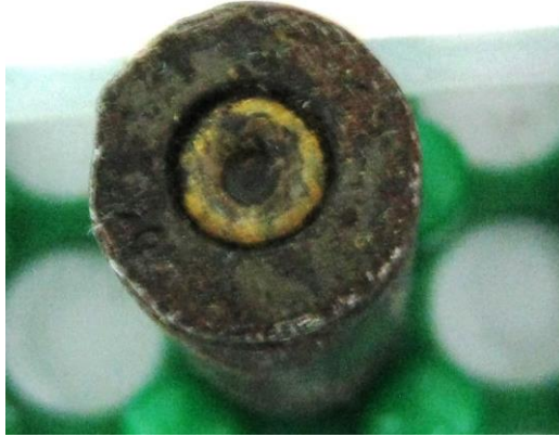
ŞEKİL: 12A- Kimyasal madde uygulanmadan önceki korozyona uğramış hali
