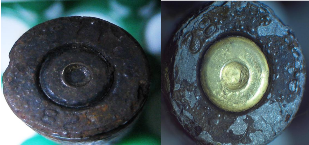
ŞEKİL: 16A- Kimyasal madde uygulanmadan önceki korozyona uğramış hali
