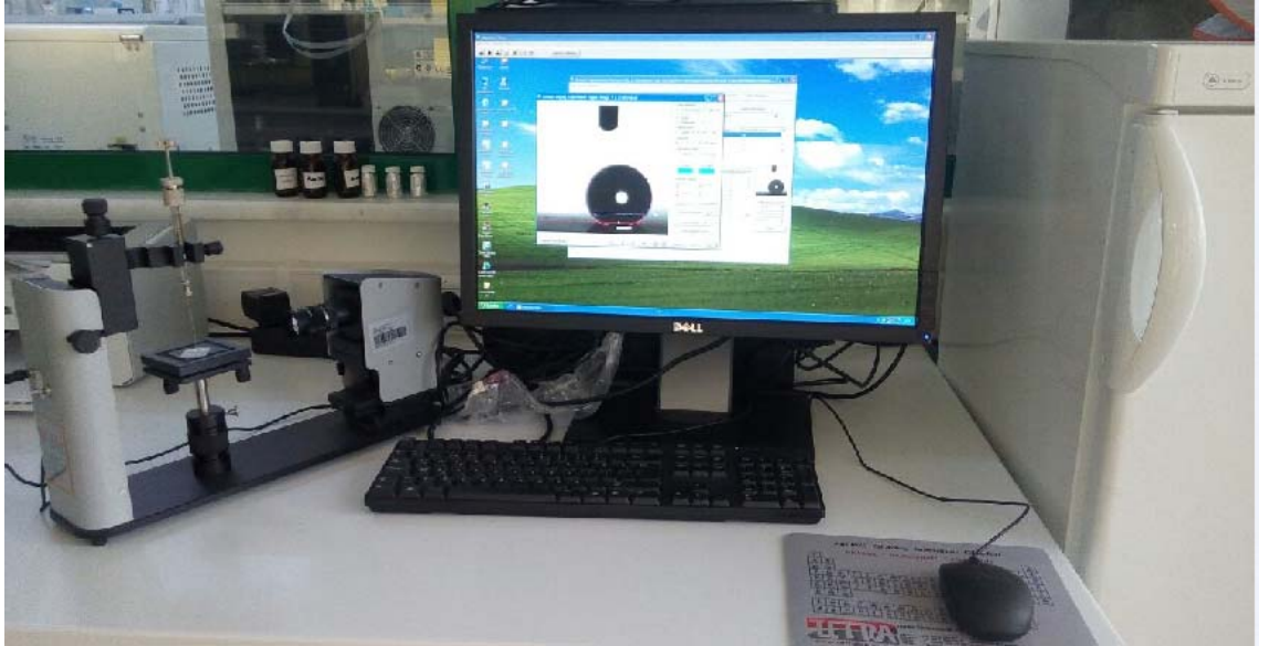
Şekil 3.2.4.1.1. Temas açısı ölçüm prensibi (KSV Instruments)
