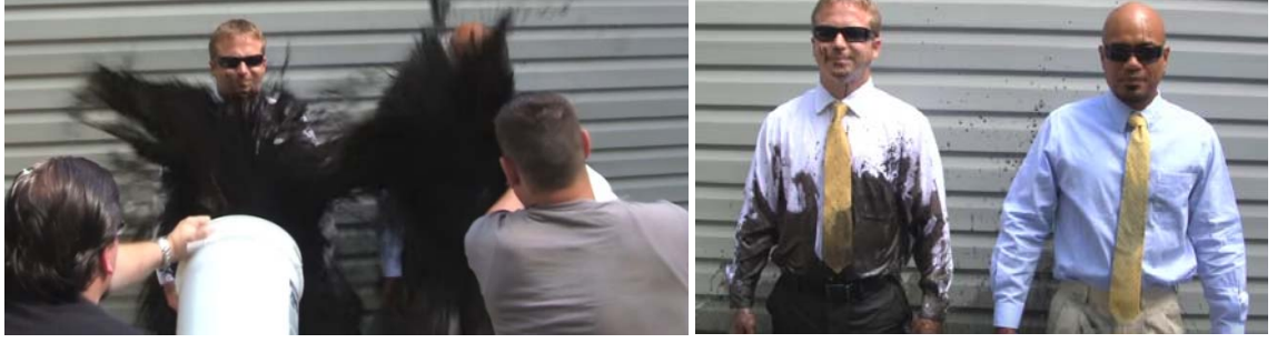
Şekil 2.5.1.2.1.4. Süperhidrofobik malzeme ile kaplanmış giysiler ve süperhidrofobik malzemeye kaplanmamış giysiler
