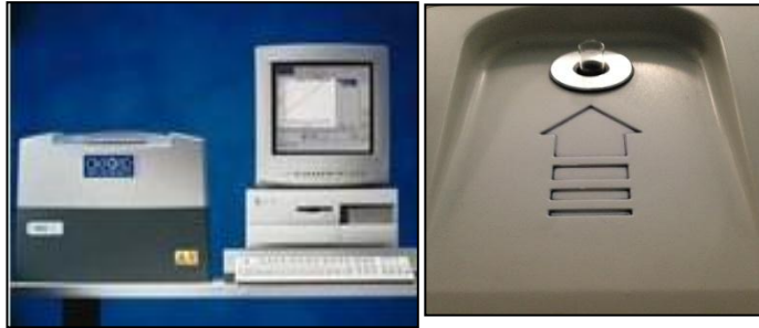
Şekil 3.5. Oxford MQA 7020 cihazı ve tüpün yerleştirildiği hazne ( www.speciation.net , 2014)
