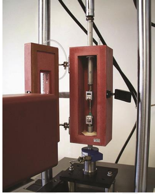
Şekil 2.3. Lazer ekstansometresi ve optik camı ile birlikte basit çekme deney cihazı ( http://www.axelproducts.com/hyperelastic.html , 2018).
