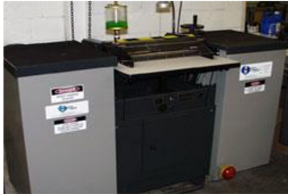
Şekil 2.10. Yığın malzemeden kauçuk levha oluşturmaya yarayan dilimleme sistemi ( http://www.axelproducts.com/hyperelastic.html , 2018).
