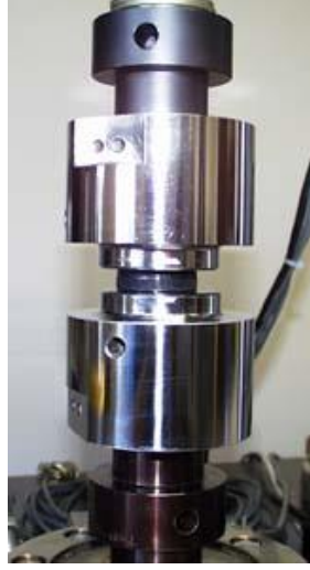
Şekil 2.8. Basit sıkıştırma deney cihazı ( http://www.axelproducts.com/hyperelastic.html , 2018)
