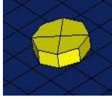
Şekil 4.22. 4-hekza katı eleman punta modeli
