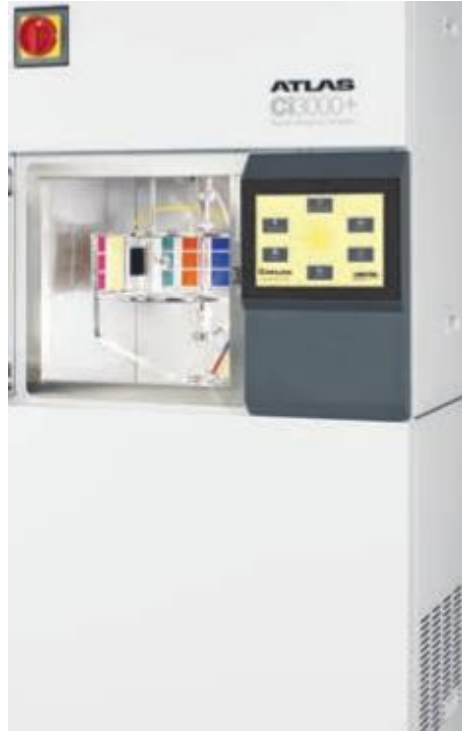
Şekil 3.3. Atlas Ci 3000+ weather-ometer test cihazı
