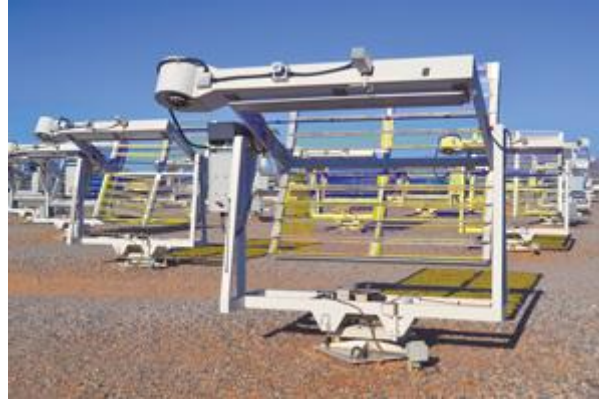
Şekil 2.15. EMMA ve EMMQUA test düzeneği
