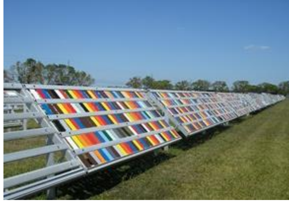
Şekil 2.14. Gerçek dış ortam şartlandırmasına bırakılmış numune örnekleri
